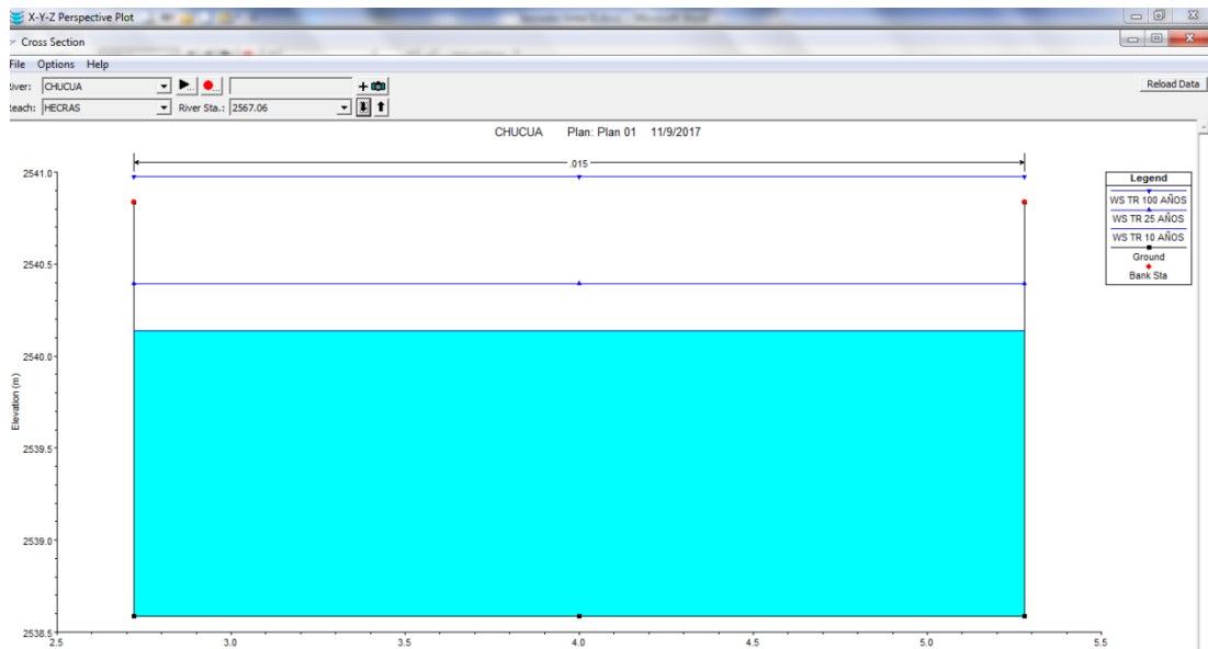
Imagen 15. Sección transversal 2567.06 condición proyectada tramo box culvert . TR 100 años Fuente: Tomado de modelo hidráulico HECRAS BOX CHUCUA-BOX TINTAL II anexo radicado SDA 2019ER212492
